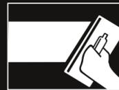
Sobre la superficie limpia y seca, sellar con SOTTOFONDO 1000, 3x1 ó 5000 y alisar con Covermix para interiores y Mascorev XT para exteriores.
